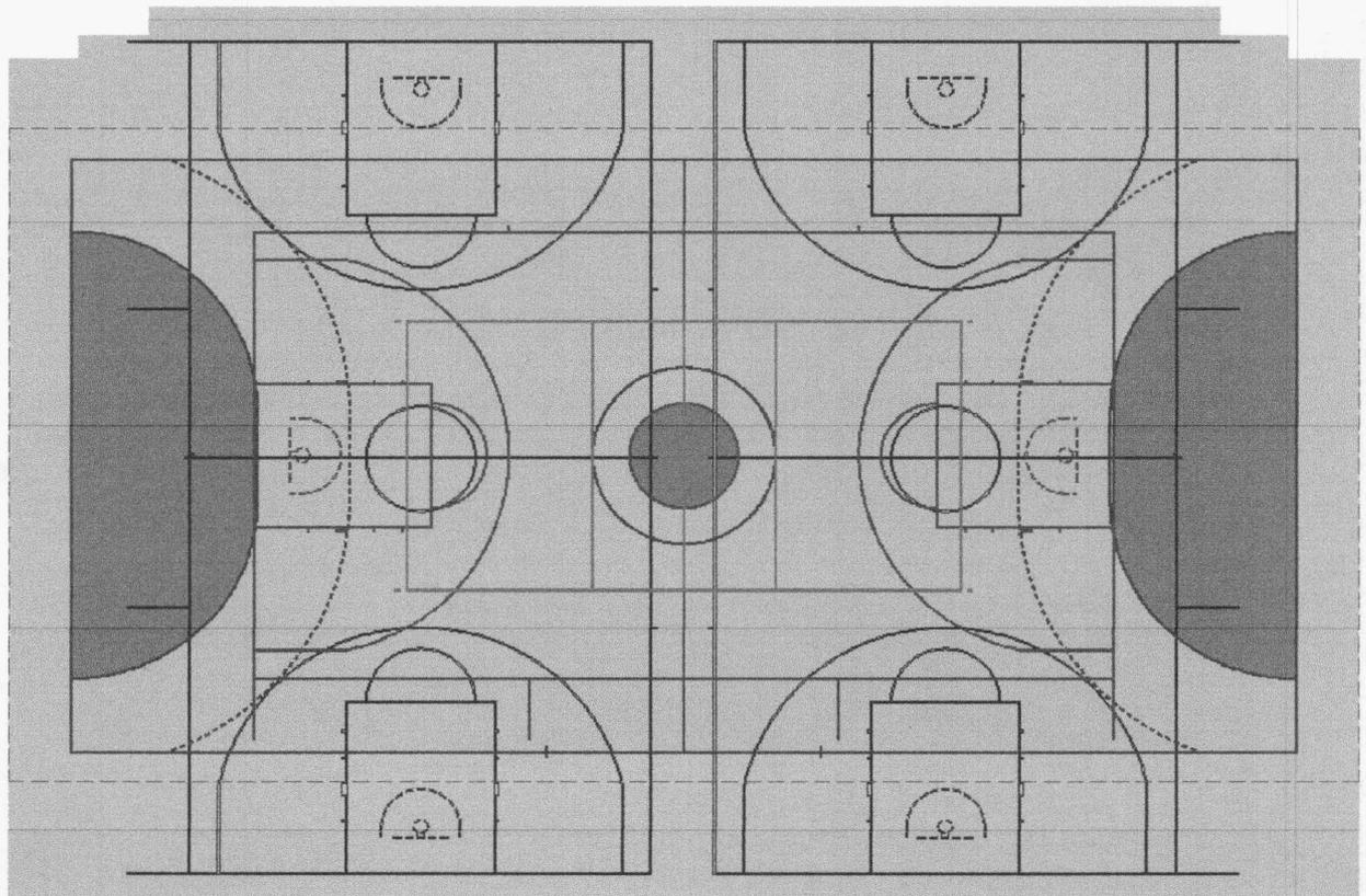
Área de piso: 1.349,15m<sup>2</sup> (Piso de concreto armado h=8cm com aditivo impermeabilizante sob lona plástica (entre o solo e o piso). Revestimento em piso sintético flexível para uso poliesportivo P.U. 9mm (3mm de P.U. e manta 6mm) coberta por camada de resina de poliuretano auto nivelam-te. Acabamento final com tinta P.U. em toda a área de piso).
