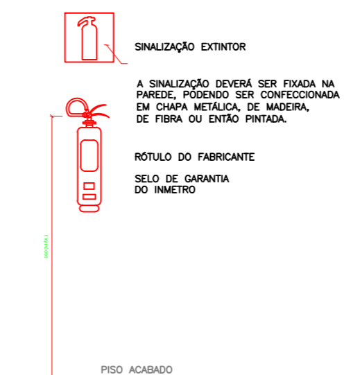
DETALHE INSTALAÇÃO EXTINTOR VISTA FRONTAL SEM ESCALA
